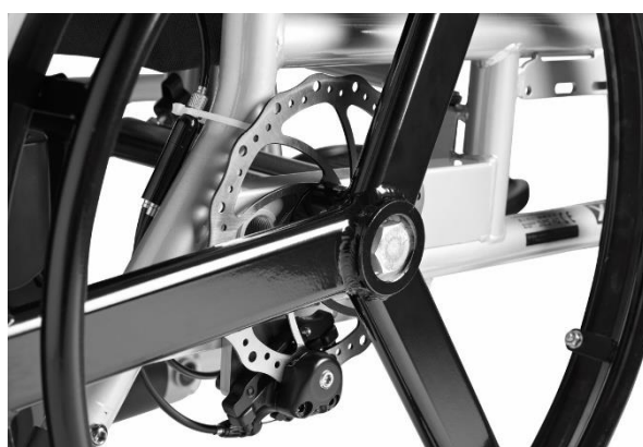
Minimaxx kørestol med skivebremser.
